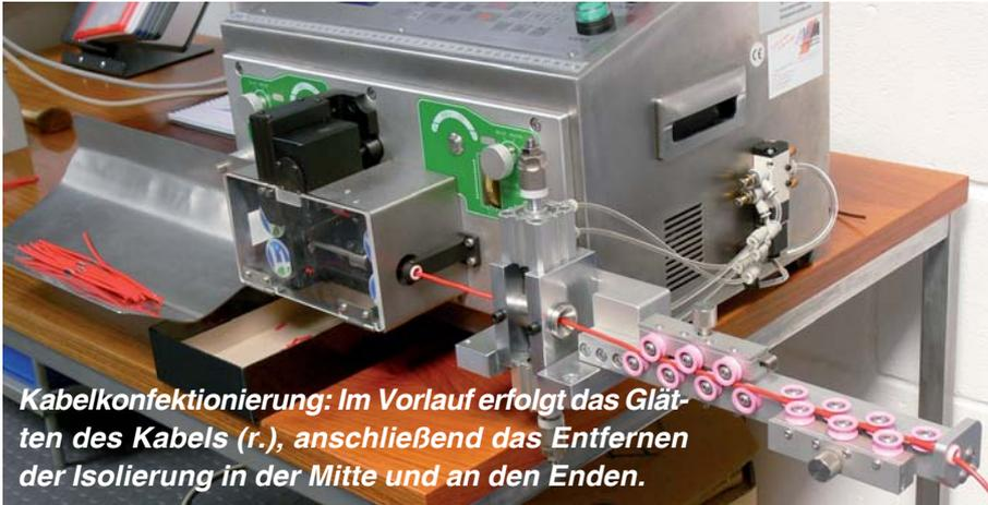
**Kabelkonfektionierung: Im Vorlauf erfolgt das Glätten des Kabels (r.), anschließend das Entfernen der Isolierung in der Mitte und an den Enden.**
