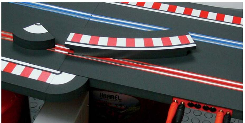
**Zu den Randstreifen gibt es auch Abschlüsse. Rechts ist der Bahnanschluss für eine 2-spurige Strecke mit zwei Transformatoren sichtbar.**
