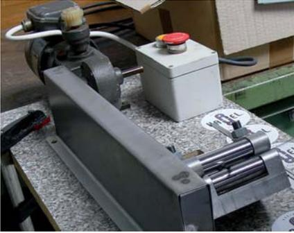
**Eine Rollpresse zum Glätten der Bahnstromleiter aus Edelstahl**
