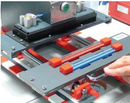
**Einbau der Stromleiter in den Powerslots (Leitkielführungen)**
