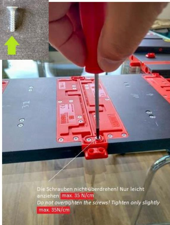
Die eingesteckten Verbinder werden mit der Harrel-Schraube S-1, wie abgebildet, verschraubt.
